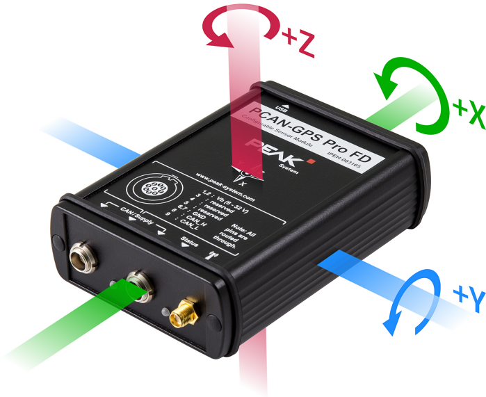
Gyroskopachsen im Verhältnis zum Gerätegehäuse Z: Gierrate (Yaw), X: Roll-/Wankrate (Roll), Y: Nickrate (Pitch)
