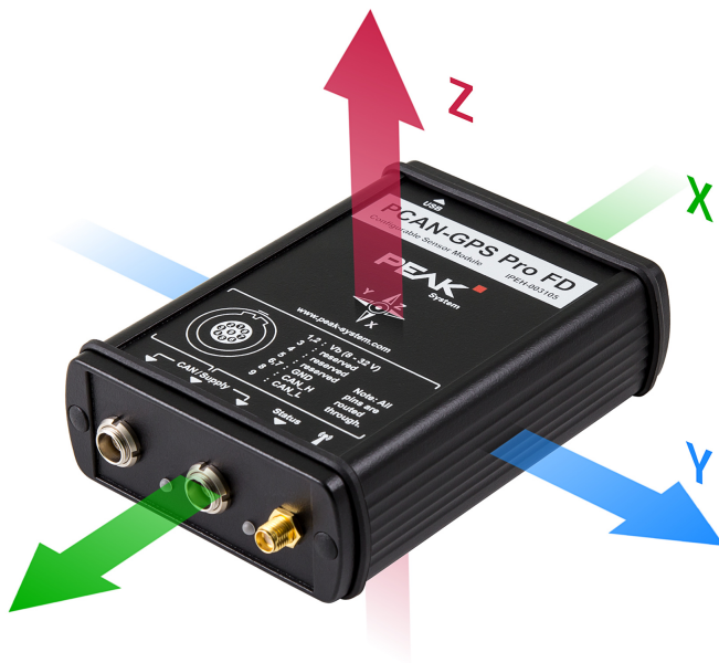
Achsen des Beschleunigungssensors im Verhältnis zum Gerätegehäuse
