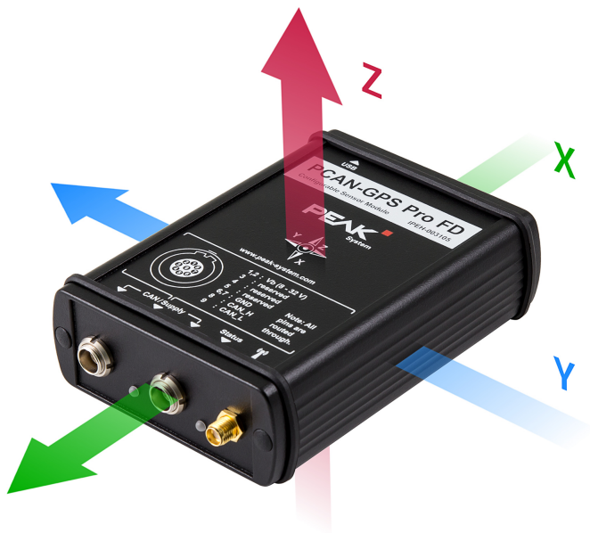
Achsen des Magnetfeldsensors im Verhältnis zum Gerätegehäuse
