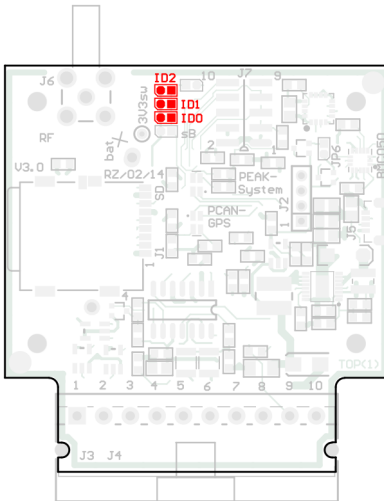
Lötfelder 0 bis 2 für die ID auf der Platine
