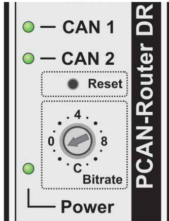
Schalterstellung F zur Aktivierung des CAN-Bootloaders
